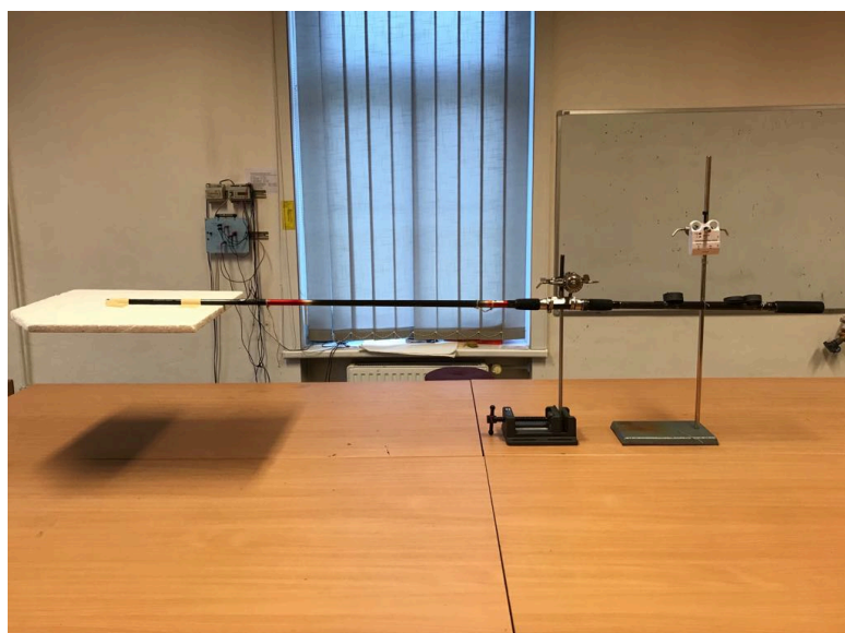
Obrázek 27: Deska připevněná na konec prutu, jehož druhý konec je zavěšen na siloměr
