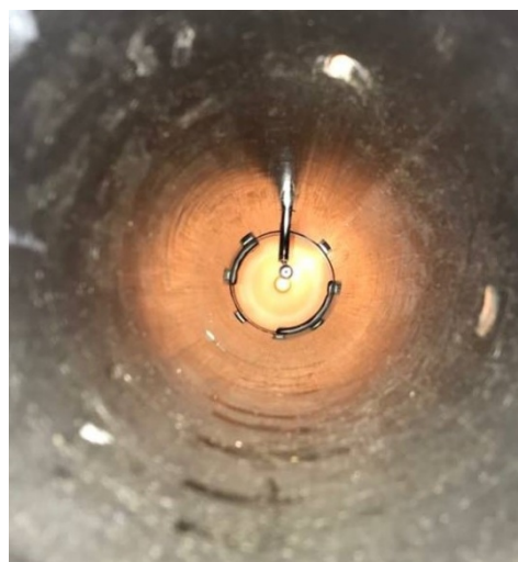
Obrázek 23: Pohled na zakončení Prandtlovy trubice zavěšené uvnitř trubky fukaru
