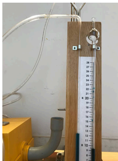
Obrázek 13: Je naměřen podtlak vůči atmosférickému tlaku
