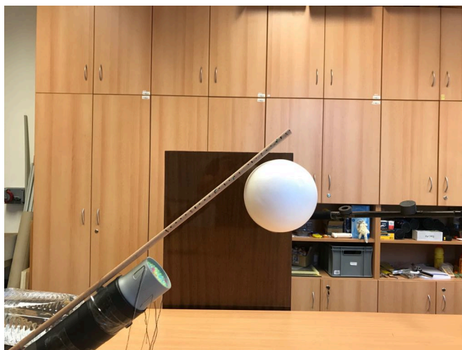
Obrázek 31: Měření pozice koule vzhledem k ústí fukaru
