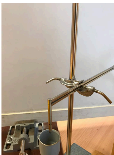
Obrázek 20: Tlak je zde měřen otvory po stranách ukončení trubice
