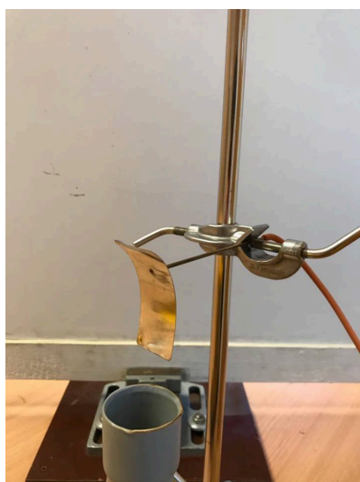
Obrázek 16: Tvar zakončení trubice způsobí změnu trajektorií letících molekul vzduchu
