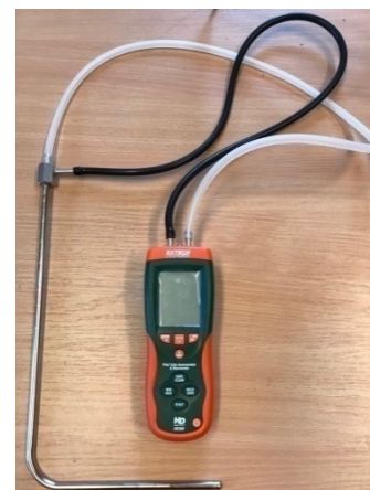
Obrázek 10: Anemometr s připojenou Prandtlovou trubicí pro měření rychlosti vzduchu
