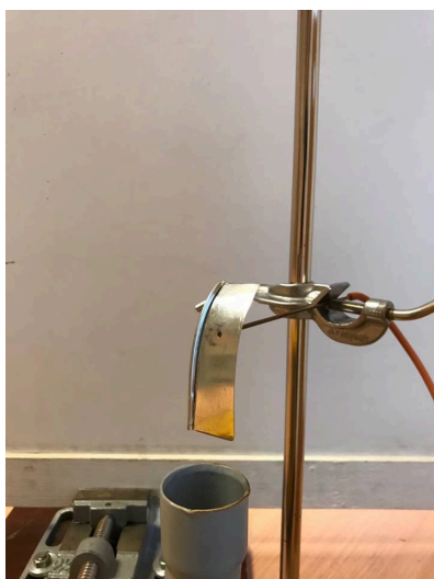
Obrázek 14: Tvar zakončení trubice způsobí změnu trajektorií letících molekul vzduchu
