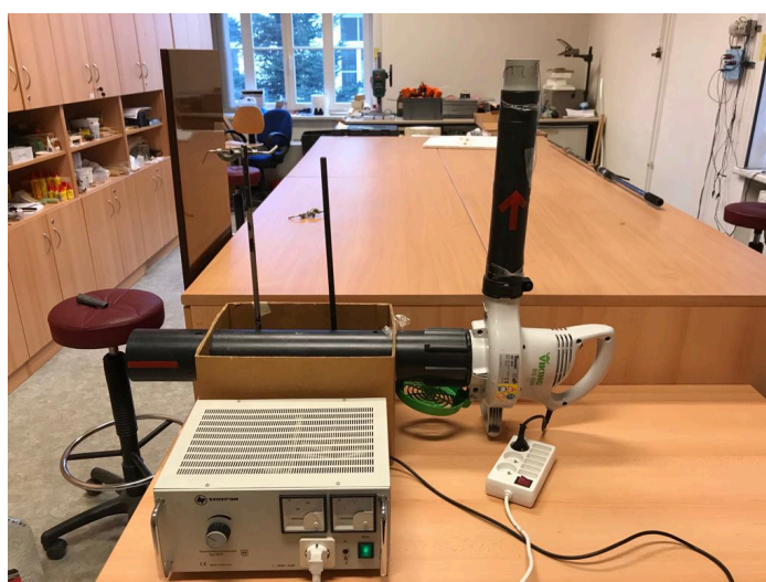
Obrázek 8: Fukar zapojený do el. sítě přes transformátor
