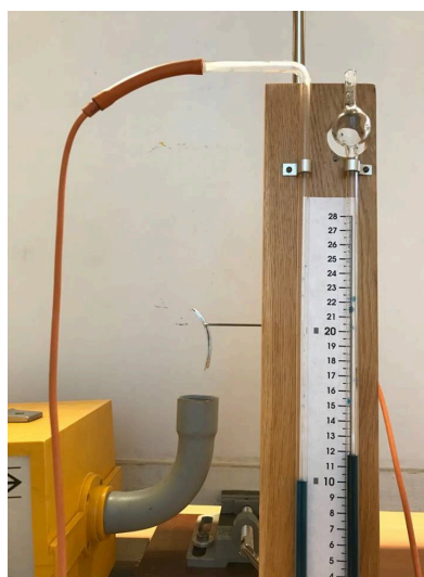
Obrázek 17: Manometr ukazuje přetlak v proudění
