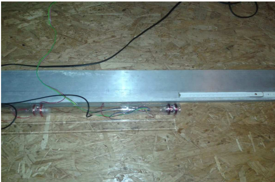
Obr. 20 - Sestava pro měření závislostí - ilustrační foto. Na obrázku je trubka se senzory a kompenzačními cívkami ve finální podobě.
