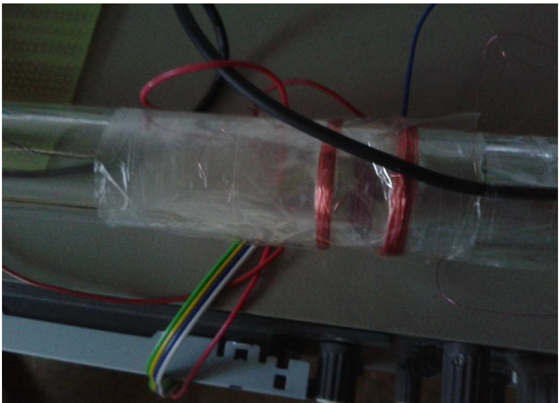
Obr. 25 - Senzor B a pohyblivé kompenzační cívky L2
